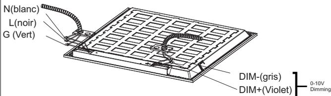
4. Remettre le capot du pilote en place et le fixer avec des vis
