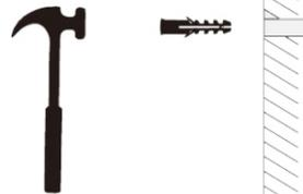
3. Utilisez un marteau pour enfoncer les ancrages d'expansion en nylon dans les trous percés dans le mur.
