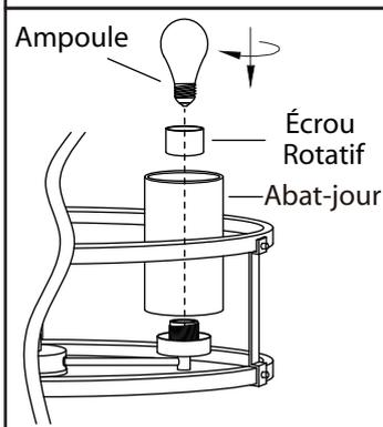
**9.** Retirez l'écrou rotatif de la douille. Positionnez l'abat-jour sur la lampe et fixez-le solidement avec l'écrou rotatif.
