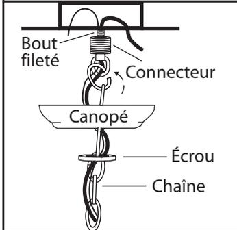
**5.** Dévissez l'écrou sur le connecteur supérieur et glissez-le vers le bas de la chaîne au connecteur inférieur. Glissez la plaque sur la chaîne vers le connecteur inférieur. Passez le fil à travers l'écrou, la plaque, le connecteur supérieur et sur le mamelon. Serrez le connecteur supérieur sur le mamelon. Écartez l'autre bout de la chaîne et attachez au connecteur supérieur. Fermez le maillon.
