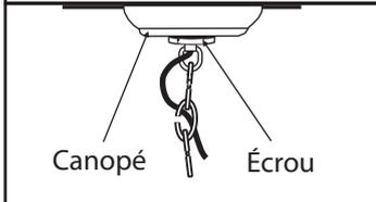
**8.** Glissez la cloche le long de la chaîne et par dessus le connecteur supérieur. Glissez l'écrou le long de la chaîne sur le connecteur supérieur.
