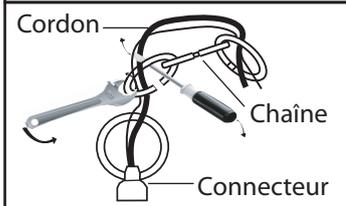
**4.** Pour relier la chaîne au luminaire, ouvrez l'un des maillons à l'aide d'un tournevis et d'une clé. Fermez le maillon. Enfillez le cordon électrique et le fil de la mise à la terre en travers des maillons de la chaîne.
