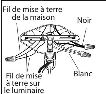
**6.** Brancher les fils de la mise à terre (cuivre nu ou vert) de votre luminaire au fil de la mise à terre (cuivre nu ou vert) ou vis de la mise à terre dans la boîte électrique. Poser le fil noir (ou fil marqué "SPT-1") de la fixture au fil noir dans la boîte électrique et poser le fil blanc (ou le fil rainuré) de la fixture au fil blanc dans la boîte.
